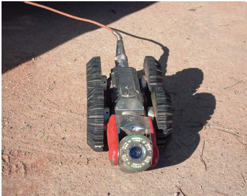
Cámara de inspección de la red
